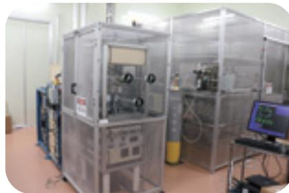
大気海洋研究所加速器実験棟にある小型AMS。シャーペンの芯先程度の微量な試料があれば測定可。クジラの鱧やヒトの歯も年代測定の試料になります。
