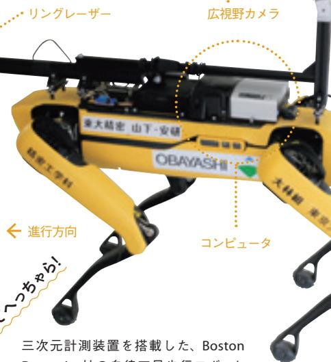
三次元計測装置を搭載した、Boston Dynamics社の自律四足歩行ロボット「Spot」。事前に移動経路を設定することで、自律歩行することもできます。計測装置を三脚に据え付けることもできますが、人の手で角度を変える必要があるため、Spotだと10分程度で終わる作業が、やり方によっては1日かかってしまうそうです。
