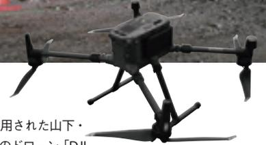
計測に活用された山下・安研究室のドローン「DJI Matrice 300 RTK」。
