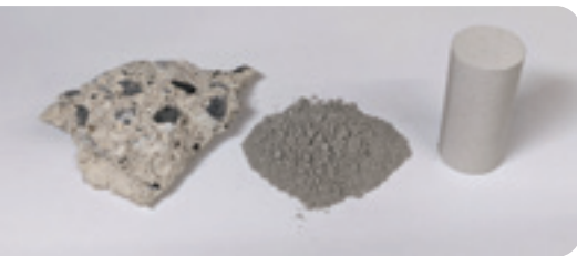
圧縮成形によるコンクリート瓦礫の再生例
