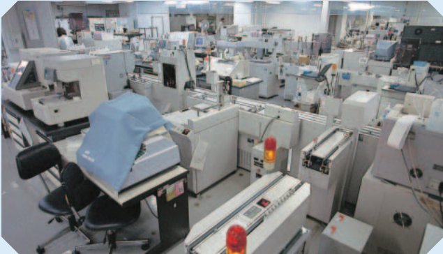
中央検査室：60余名の臨床検査技師が従事している。写真は自動検体搬送装置。毎日、外来・入院あわせて約5,000件を処理している
