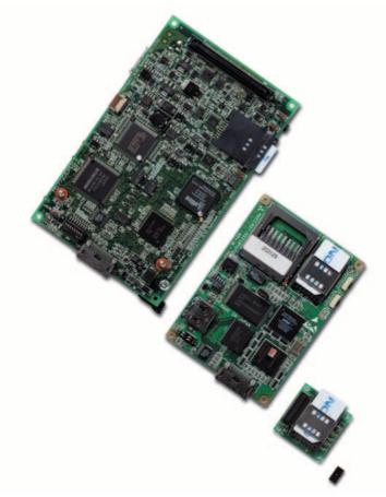
T-Engine は組み込みシステム用の標準開発環境であるが、ミドルウェア流通 を保証するためにハードウェアについても標準ボードが規定されている。写真は、 大きいほうから、標準、マイクロ、ナノ、ピコの各 T-Engine。 マイクロまでは リリースされており、ナノはオールインワンチップのマイコンで仕様規定中、ピ コはRFインタフェースを前提とする、スマートRFIDとして開発中のものである。
